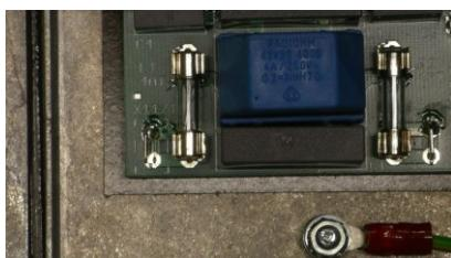
Volte a colocar o aparelho (ainda por abrir) sobre a parte traseira e retire a tampa da caixa. Agora pode substituir os fusíveis avariados por novos. (micro fusível 4x20 mm 4AT)
